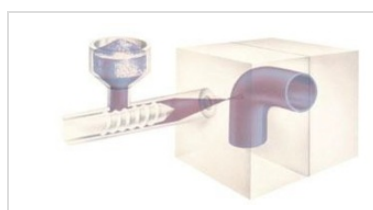
Figur 2.5 - Sprøytetøping av rørdeler
