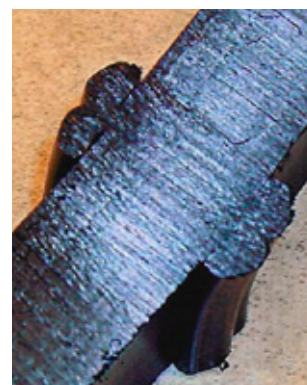
Svetsvulster på en PE ledning, tvärsnitt genom en stumsvetsfog.
