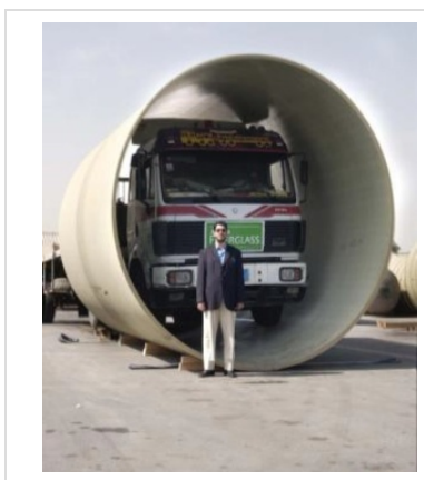
Figur 3.12 - GRP kan leveres med diameter inntil 4000 mm
